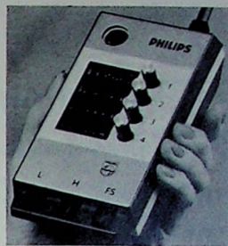
Bild 13. Seitlich herausgeklappte Konvergenzleiste des Farbfernsehempfängers „Goya SL“ von Philips
