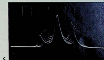
Bild 15. Oszillogramme zur Demonstration der Resonanzformen des Filters nach Bild 13; a) Durchlaßkurve des abgeglichenen Filters, b) Durchlaßkurven bei schrittweiser Verstimmung eines äußeren Kreises, c) Durchlaßkurven bei schrittweiser Verstimmung des mittleren Kreises, d) Durchlaßkurven bei schrittweiser Verstellung eines Widerstandes
